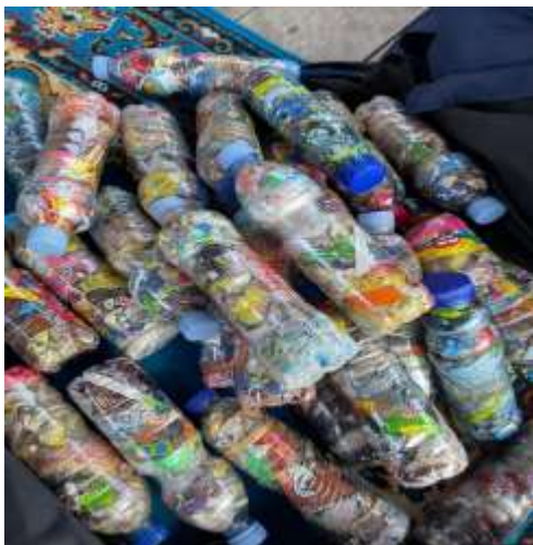
Gambar 2. Proses Pengisian dan Pemadatan Sampah Plastik ke dalam Botol
